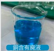
銅含有廃液について銅濃度が3%以上で有価物となります。発生工程の薬液タンクより排出された液を回収し年間1,500tの廃液を有価物化しました。
