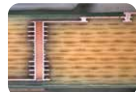
多段ビルドアップ基板 断面
