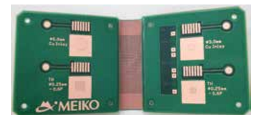
多機能統合パワー基板 (小型化、大電流、放熱、3D実装)
