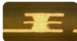
薄板パッケージ基板(3層コアレス)断面
