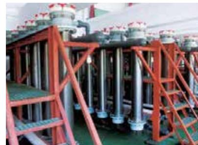
写真：広州工場のソフトエッチング廃液処理装置
