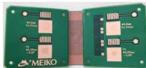
多機能統合パワー基板 (小型化、大電流、放熱、3D実装)
