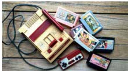
1983年に発売された家庭用ゲーム機。ゲーム機本体のほかにゲームソフトウェアを搭載したカセットにも電子回路基板が使用された。
