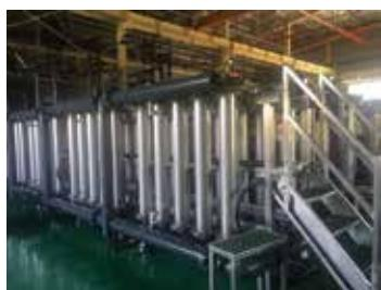
写真1:ベトナム工場の金属銅回収措置
