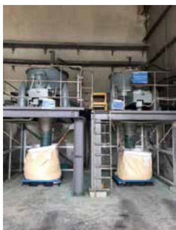
写真2:ベトナム工場の炭酸銅回収措置
