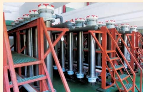
写真：広州工場のソフトエッチング廃液処理装置
