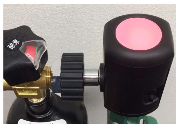
酸素ボンベ容量低下時（赤色点滅,通知音）
