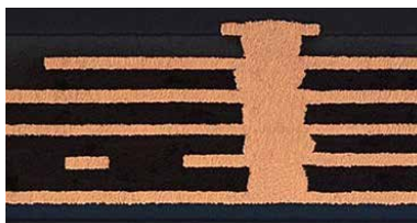
6層コアレス基板 断面写真 6L Core Less Substrate Cross section
