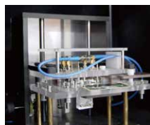
フィクチャー治具による測定器接続
